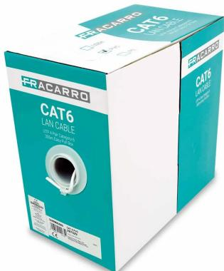
Cable de red CAT 6 para interiores con revestimiento de PVC, bobina de 305 metros compuesta por 4 pares balanceados de 100 ohmios con conductores de cobre rojo flexibles AWG 24. Las características cumplen con los requisitos de la categoría 6 Clase E hasta 250 MHz, según las normas ANSI/TIA 568.2-D e ISO/IEC 11801. Apto para aplicaciones Gigabit Ethernet (IEEE 802.3ab).
